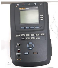
รูปที่ 10 เครื่อง Electrical Safety Analyzer ยี่ห้อ FLUKE รุ่น ESA615 สำหรับทดสอบความปลอดภัยทางไฟฟ้า
