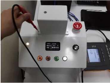
รูปที่ 15 ทดสอบค่ากระแสไฟฟ้าวัดที่ตัวเครื่อง (Chassis leakage current)
