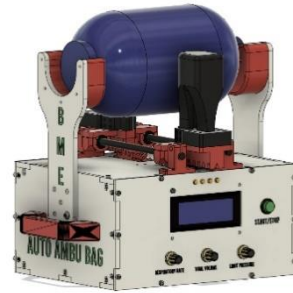
รูปที่ 5 แสดงภาพเครื่องโครงสร้างภายนอกของเครื่อง Auto AMBU Bag
