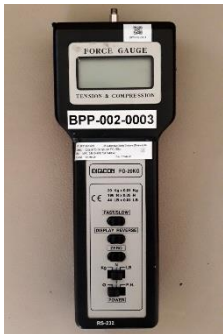
รูปที่ 9 เครื่อง Force Gauge สำหรับทดสอบแรงดึง
