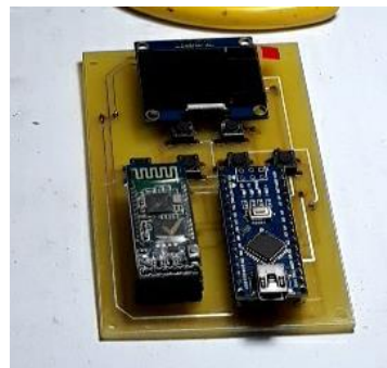
รูปที่ 7 วงจรและอุปกรณ์ของรีโมท
