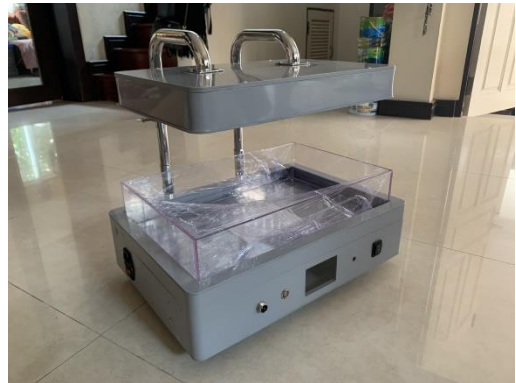
รูปที่ 5 เครื่องส่องไฟรักษาทารกภาวะตัวเหลือง อังกริยะ แบบแอลอีดีที่ทำการพัฒนาขึ้น
